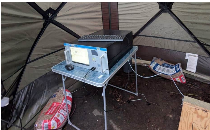
Analyseur BTEX installé sur le site de La Rochelle
